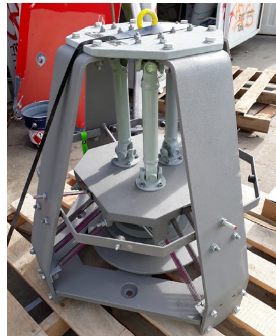
Tuned Mass Damper (TMD): 8-eckige Pendelmasse, aufgehängt an 3 Pendelstangen mit Kardangelenken, darunter 4 übereinander gestapelte Reibplatten und die Tuning-Federn zwischen Gehäuse und Pendelmasse für die Frequenz-Einstellung. Die spezielle Form des Gehäuses erlaubt den horizontalen Einbau der Dämpfer in die ca. 20 ° geneigten Red Sticks.
