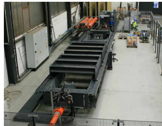
Blick auf die komplette neue Prüfanlage im MAURER-Stammwerk in München. Das Gesamtareal misst 10x30 m, inklusive Druckflaschen und Rechnerstation im Hintergrund.
