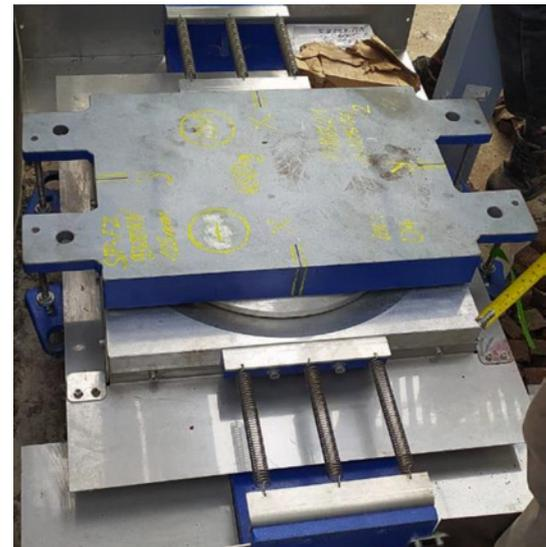
Die Speziallager in der Produktion, sichtbar sind das Lageroberteil und die Federn für die Rückzentrierung.
