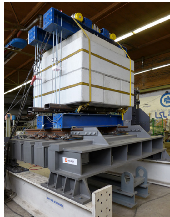
Prüfstand für den 10-km-Gleitwegtest und Ermüdungstest. Dabei kam es zu keinerlei Verschleiß in den beweglichen Bauteilen der Wanderschwelle.
