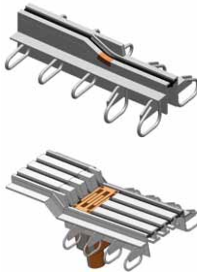
6 7 Ausgerundete Profilführung an Schrammbord und Dichtprofilentwässerung © Maurer Söhne GmbH & Co. KG
