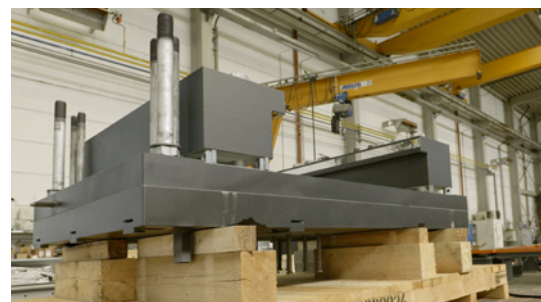
In der Produktion bei MAURER: Gut zu erkennen die äußeren Klammern mit Gleitplatte (glänzend), die ein Öffnen der Lager bei abhebenden Kräften verhindern.
