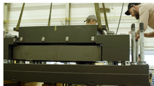
In der Produktion wird das Mittelstück, also das eigentliche Lager, eingeschoben.
