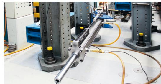
Teststand bei der EMPA in Dübendorf (Schweiz), wo die Funktion der semiaktiven Dämpfer bestätigt wurde.
