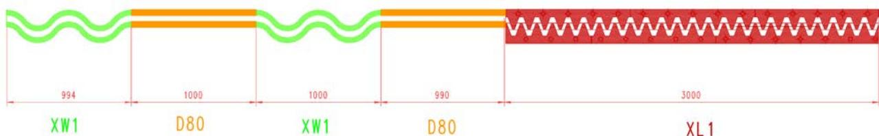
Abb. 1 - MAURER Dehnfugen - Anordnung im Grundriss
