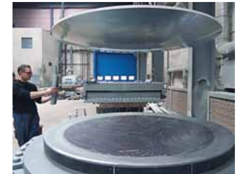
Apoyo esférico MSM® MAURER para una carga vertical de 220.000 kN
