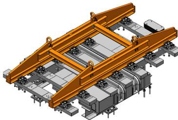
Die Wanderschwelle wird mit einem speziell entwickelten Transportrahmen als Bauteil geliefert. Innerhalb des Rahmens sind die Schwellen in Längsrichtung verschiebbar, um schnell und einfach Anpassungen während der Installation an den jeweiligen Verschiebezustand des Bauwerks zu ermöglichen.
