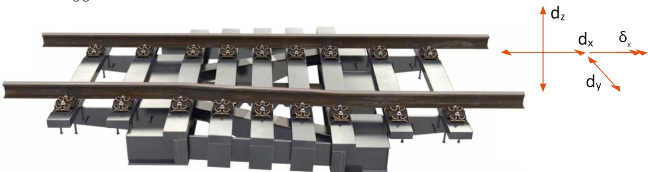
Die Wanderschleife wurde für eine minimale Aufbauhöhe von 450 mm der Festen Fahrbahn gemäß RIL 804.5202 entworfen. Zwei Anschlussvarianten werden berücksichtigt: Die Konstruktion kann über eine Anschlussbewehrung kraftschlüssig mit dem Tragwerk gemäß der RIL verankert werden oder über eine Anschlussbewehrung an den Ausgleichsbeton der Festen Fahrbahn angeschlossen werden ohne Schutzbeton und Abdichtung zu durchbrechen.
