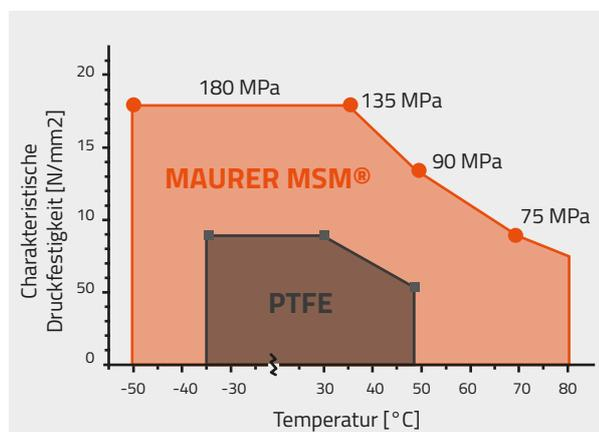
Druckfestigkeit-Temperatur-Diagramm für PTFE und MSM®
