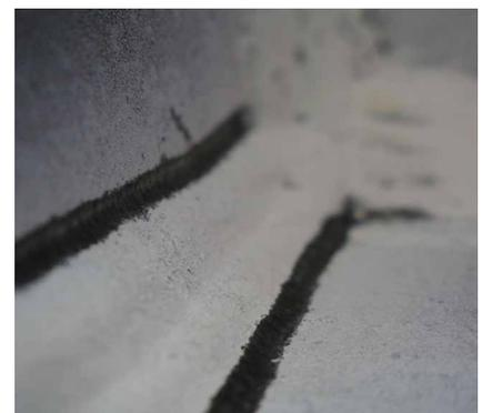
Schweißnaht nach dem hochfrequenten Hämmern
