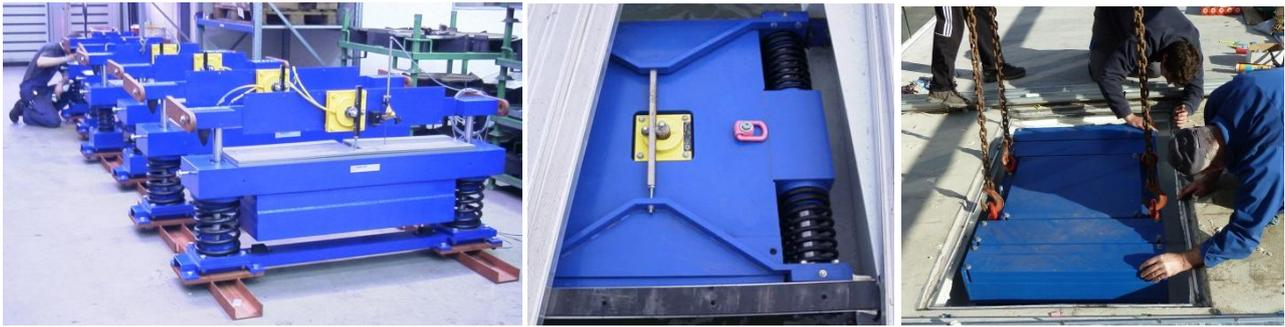
Abb. 2 – *standardTMD* und *controlledTMD* in vertikaler und horizontaler Ausführung und präziser Einbau im Bauwerk
