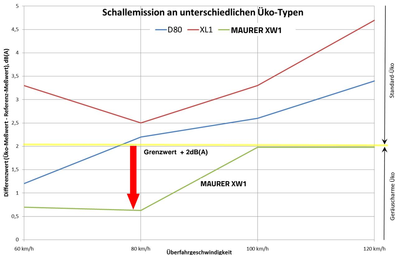
Abb. 2- Diagramm Schallemissionen Üko-Typen
