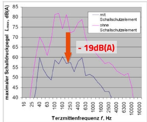
Abb. 3 - Schalldruckpegel-Reduktion durch GU-f
