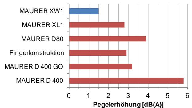
Abb. 1 - Schallpegeldifferenz zwischen Dehnfuge und Fahrbahn
