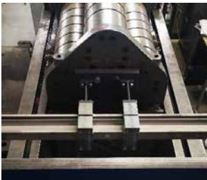
Ermüdungsversuch MSM® Schwenktraversen Dehnfuge
