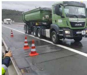
Überrollversuch MSM® Schwenktraversen Dehnfuge
