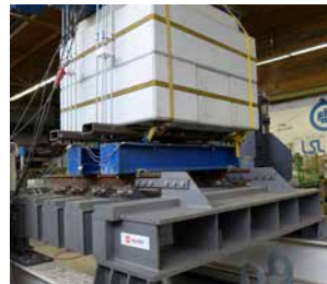
Dynamischer Versuch Wanderschwelle
